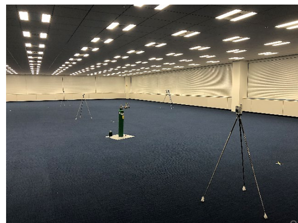
トレーサーガスによる換気量、空気齢測定
