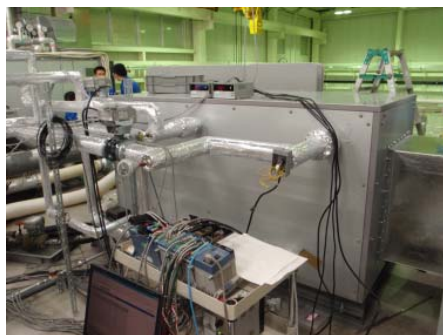
空調機1/4縮小モックアップ実験機
